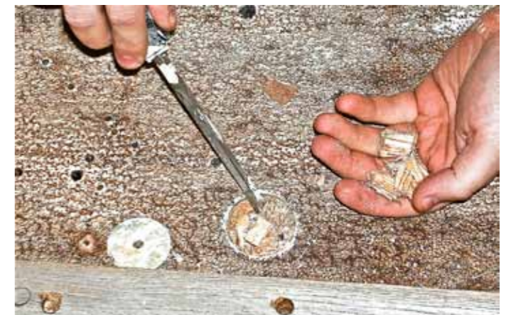
Balsaträet i sandwichlaminatet är blött. Efter uttorkning valde kunden ett korkdäck.
