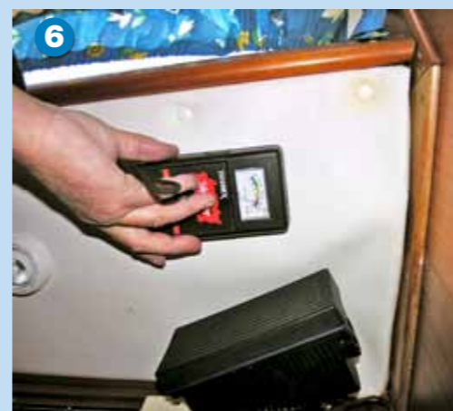
Tre saker är påtagliga. Självklart utslaget på fuktmatören. Men fränsett den kan du se att taggarneringen hänger på navigationsinstrumentet. Notera kanten på taggarneringen och dess vita linje som kröker mot trälisten till höger samt att fästknappen i hörnet har gulnat.
