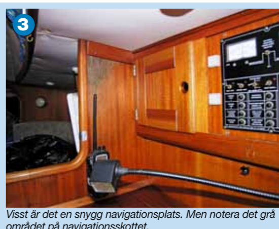
Tre saker är påtagliga. Självklart utslaget på fuktmatören. Men fränsett den kan du se att taggarneringen hänger på navigationsinstrumentet. Notera kanten på taggarneringen och dess vita linje som kröker mot trälisten till höger samt att fästknappen i hörnet har gulnat.
